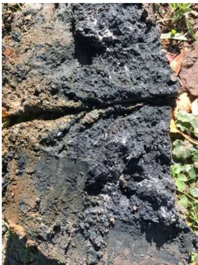
Foto č.4: Zcela zvětralé horizonty amfibolitu – J2
