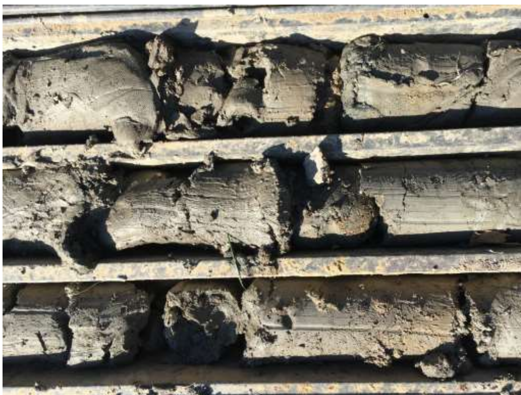
Foto č.2: Detail měkkých poloh jílovito-písčitých zemin – sonda J1
